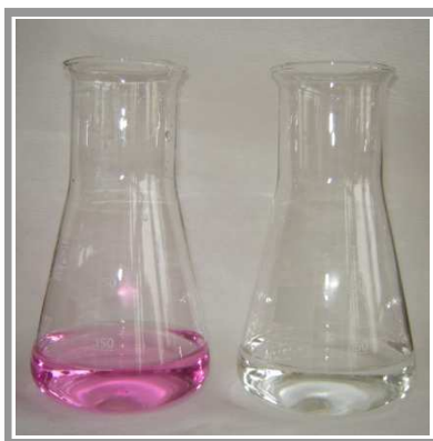
Slika 8. Promjena boje pri kompleksometrijskom određivanju Zn uz 3,3-dimetilnaftidin.
