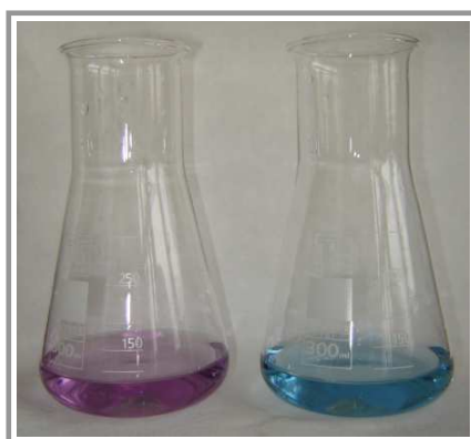
Slika 4. Promjena boje pri kompleksometrijskom određivanju Zn uz eriokrom crno T.
